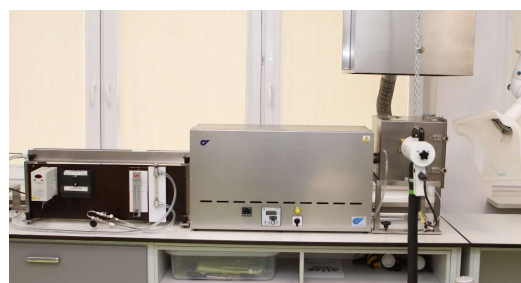
Zdjęcie stacjonarnego pieca rurowego (tzw. Piec Pursera)
